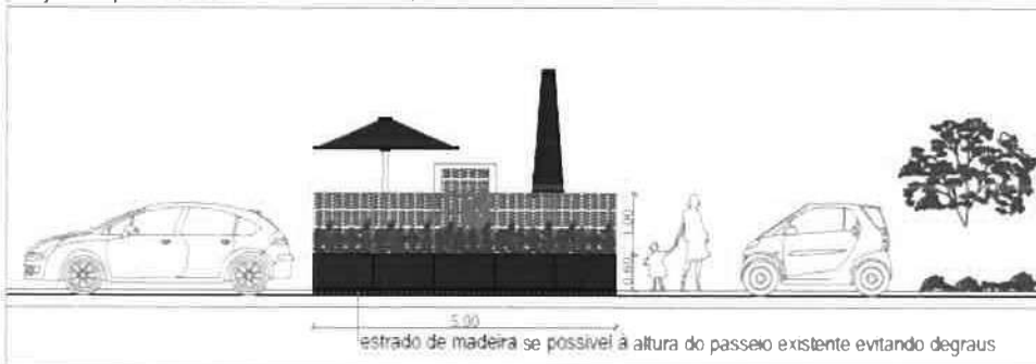
ALÇADO Tipo 2 - Módulos de estacionamento 2,50x5m
