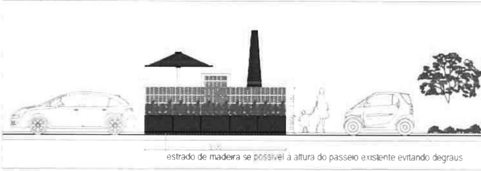
ALÇADO Tipo 2 - Módulos de estacionamento 2.50x5m
